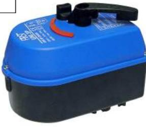
Приводы FIRŠT серии UNI 3P управляются трехточечным способом и предназначены для работы 2, 3 и 4-ходовых поворотных клапанов (DN 15 - DN 50).
